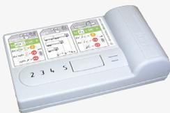
Il s'agit d'un dispositif permettant le règlement des redevances autoroutières par voie électronique.
