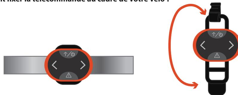
Fixez la télécommande en enroulant l'attache caoutchouc autour de la barre du guidon.
