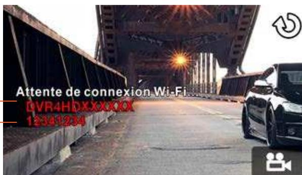
4. Avec la fonction Wi-Fi d'un appareil mobile, recherchez l'ID de l'appareil dans la liste et sélectionnez-le, puis saisissez le mot de passe Wi-Fi.
